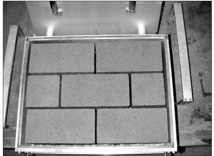
**Bild 2:** Versuchsapparatur mit regelkonform verlegten Pflastersteinen
