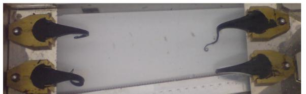
**Bild 2:** Fadenringelung bei der Elastischen Rückstellung der Variante 7 bei einer Temperatur von 35 °C und einer angestrebten Auszugslänge von 20 cm (Stufe 2)
