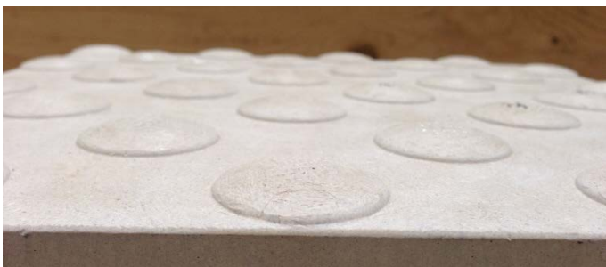
Bild 6: Im Test verwendete Kegelstümpfe mit großem Durchmesser [Foto: Boenke]
