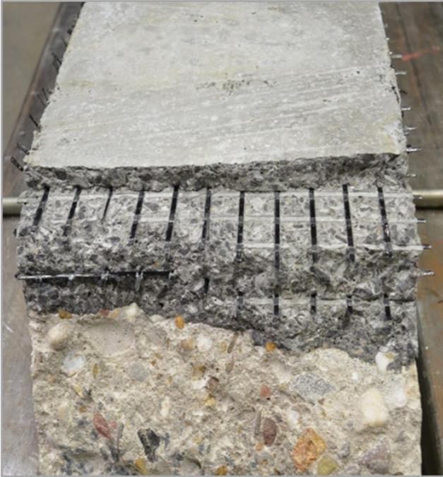
**Bild 3: CRC-Schicht nach Versagen (Reißen der Carbonbewehrung)**
