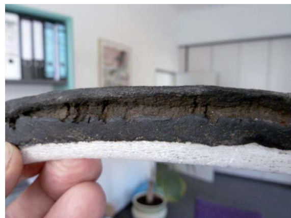
Bild 6: Ausgebautes schadhaftes Fugenmaterial mit Unterfüllstoff
