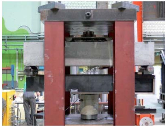
Bild 9: Versuchsstand für zyklische Belastung von Straßenbetonbalken
