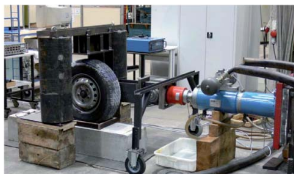
Bild 13: Einwalkung von Taumitteln in vorbelastete Probekörper durch Überrollung
